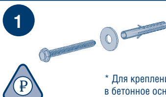
Рис. 7.26. Саморез-глухарь 6,3 × 38 мм + дюбель ПВХ
